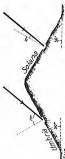
FIG. 46. — Influencia de la "exposición", en la intensidad de los rayos solares.
