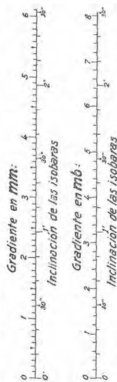
FIG. 182. — Inclinación de las isobaras en dependencia del gradiente de presión, expresado en milímetros y en milibares.
