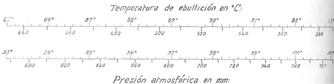
FIG. 174. — Relación entre la temperatura de ebullición del agua y la presión atmosférica reinante.
