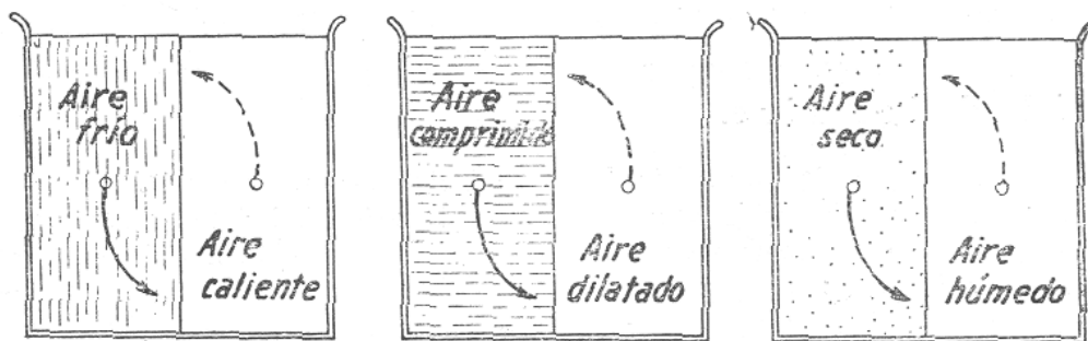
FIG. 180. — El aire trata de acomodarse conforme a su densidad. El aire frío desaloja al aire caliente, el aire comprimido al aire dilatado y el aire seco al aire húmedo.
