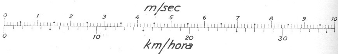
FIG. 197. — Gráfica para transformar velocidades expresadas en m/sec, en km/hora, y viceversa.
