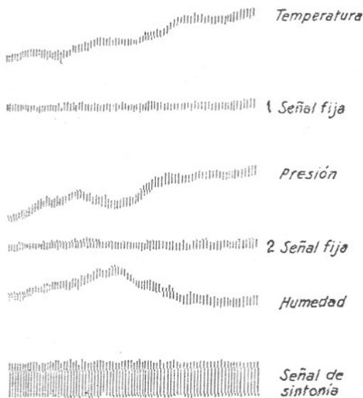
FIG. 355. — Registro de las señales emitidas por la radiosonda anterior.
