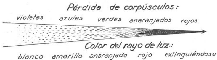
FIG. 386. — Cambios que se producen en la coloración de un rayo de luz, al atravesar éste la atmósfera.
